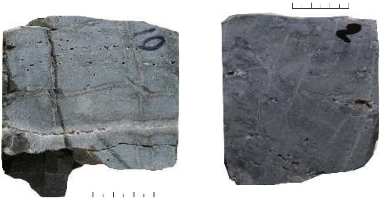
Рисунок 5.5 - Пустоты выщелачивания вдоль макро- и микротрещин
