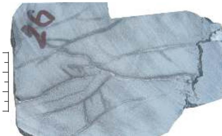
Рисунок 5.8 - Закрытые трещины, выполненные углеродистым веществом
