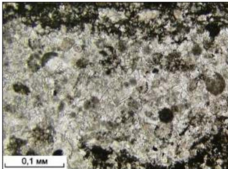
Рисунок 5.14 - Перераспределение углеродистого вещества в перекристаллизованном известняке
